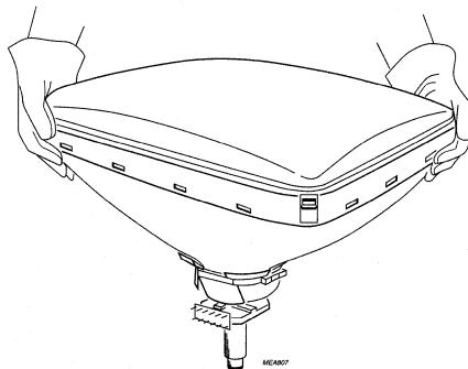
Abb.2 Anheben der Röhre aus der Position Röhrenhals nach unten.
