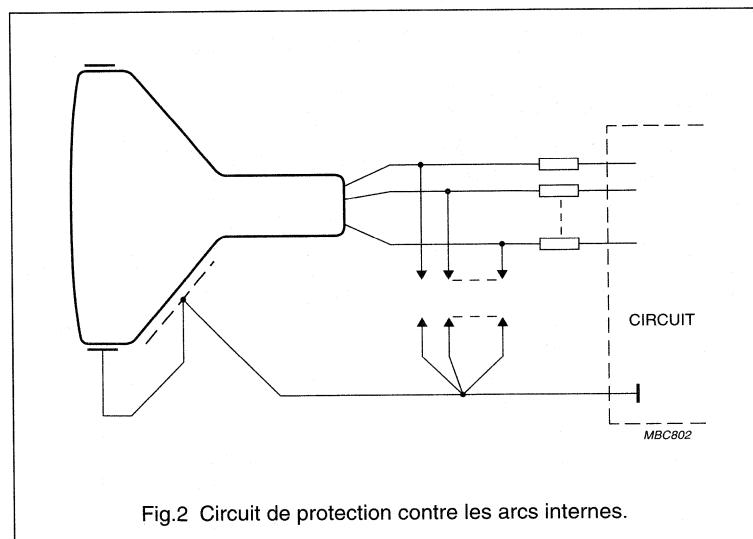
Fig.2 Circuit de protection contre les arcs internes.
