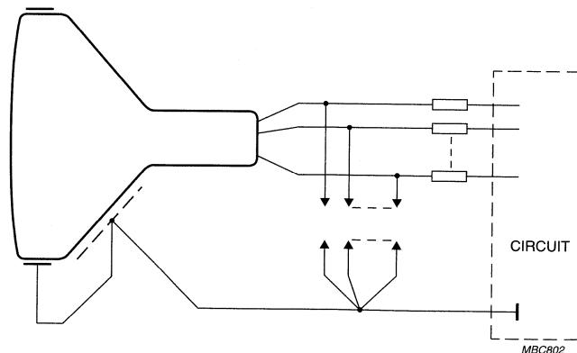
Fig.1 Flashover protection circuit.
